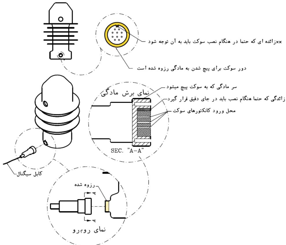
بعد از بستن مادگی سوکت به مقره، ابتدا فاصله بین مقره بزرگ و مادگی و مقره را با نوار بوتیل پر نموده و نوار را روی مهره ادامه می دهیم. سپس بقیه بوتیل را در محل خروج کابل از مادگی برای آب بندی می پیچیم و آنگاه با استفاده از ششوار صنعتی لوله حرارتی قرمز را بر روی مادگی به گونه ای حرارت می دهیم که عملیات آب بندی درزهای سوکت و درز کابل گیر به دقت انجام شود.
