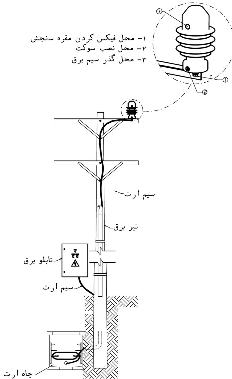
جهت عبور جریان حتما مطابق با جهت فلش بر روی مقره سنجش باشد (مطابق شکل زیر)
