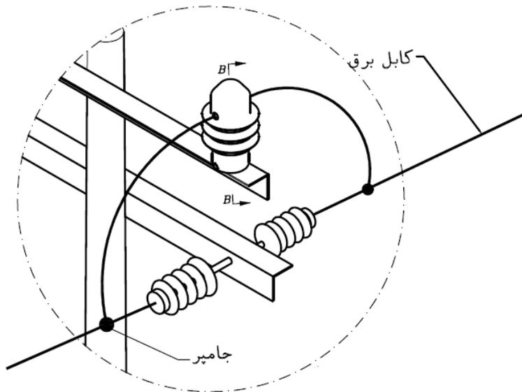
دو قطعه گوه فلزی را جهت ثابت نگه داشتن سیم عبوری، در داخل لوله مقره سنجش قرار داده و با پیچ مربوطه بر روی کابل فیکس می کنیم.
